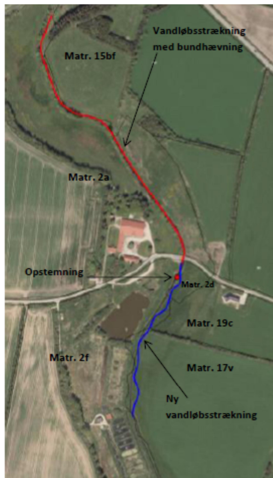
Figur 4. Skitseforslag med et slynet vandløb nedstrøms Damsgårdvej, og en bundhævning i vejunderføringen samt opstrøms Damsgårdvej.
